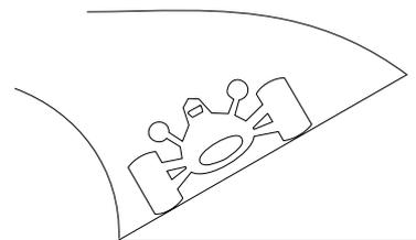
28.- Un vehículo toma una curva peraltada que tiene rozamiento a una velocidad máxima  $v$ , para no derrapar. La tangente del ángulo que forma el suelo de aquella con la horizontal vale:
